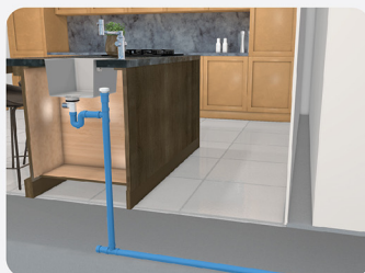
ระบบวาล์วเติมอากาศเดอร์โก (DURGO AAVs) ลดระบบท่ออากาศ
